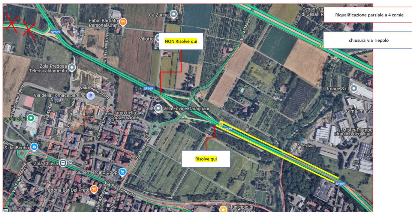
Figura 54: Riqualificazione a 4 corsie della SP 569 Bazzanese con corsie di accelerazione per le immissioni da e per via Masini, chiusura di via Tiepolo
